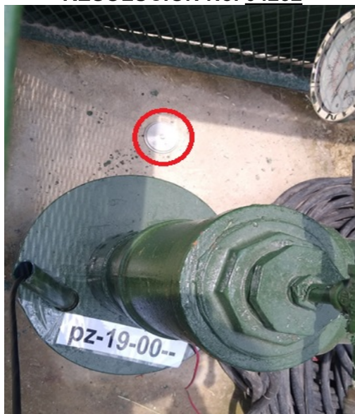
Fotografía 7. Placa de georreferenciación y nivelación del pozo pz-19-0027
