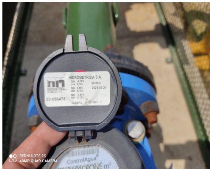
Fotografía 6. Certificado de calibración del medidor volumétrico 20 096473
